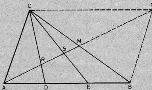
Demostraremos que  $\overline{RD} : \overline{RC} = 1:3$  y que  $\overline{SE} : \overline{SC} = 2:3$
