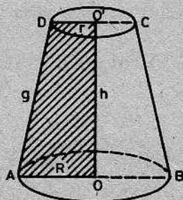
2) Es un cuerpo de revolución que se engendra al girar en  $360^\circ$  un trapecio rectángulo  $AOO'D$  en torno a su lado  $\overline{OO'} \perp$  a las bases. Este lado  $\overline{OO'}$  es el eje del cono truncado y el lado  $\overline{AD}$  que engendra el manto es la generatriz.
