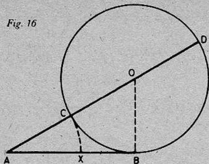
4) Con centro en A y radio  $\overline{AC}$  se corta el trazo dado; se determina el punto X que debe cumplir con la tesis:
