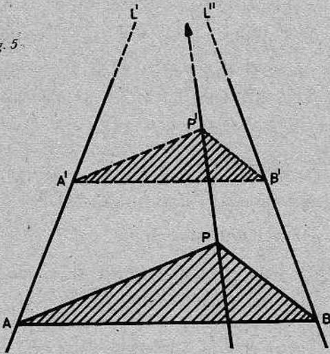
*Solución:* 1) Se dibuja un triángulo cualquiera  $ABP$  siendo  $P$  el punto dado; 2) se traza una paralela cualquiera  $A'B'$  al lado  $AB$ ; 3) por  $A' // AP$  y por  $B' // BP$  determinan  $P'$ ; 4) la recta  $PP' \rightarrow P'$  pasa por el vértice del  $\sphericalangle$  ( $L', L''$ ).
