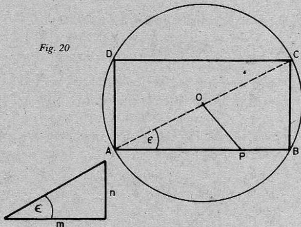
*Indicación:* 1) con m y n se determina el ángulo  $\epsilon$ ; 2) se dibuja el arco capaz de  $\epsilon$  con cuerda  $\overline{OP}$ ; 3) la intersección de este arco con la circunferencia dada determina A, etc.
