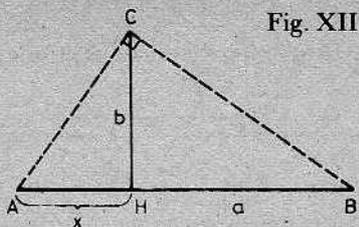
3) se une B con C y se traza en C la perpendicular a  $\overline{BC}$  la que determina A en  $\overline{BH} \rightarrow H$ .
