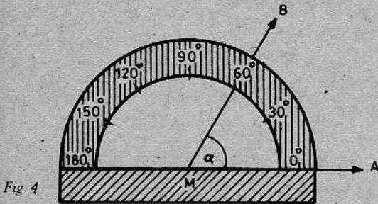
Para medir un ángulo con este sencillo aparato se hacen coincidir el punto medio M del diámetro del transportador con el vértice del ángulo a medir y el lado  $\overline{MA}$  del ángulo con la dirección  $\overline{M0^\circ}$ . Finalmente, basta leer con qué número de la escala coincide el otro lado  $\overline{MB}$  del ángulo. (En el dibujo:  $\alpha = 60^\circ$ .)
