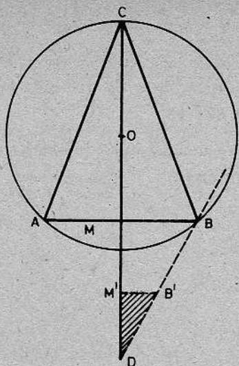
copiar una magnitud cualquiera »n« de modo que  $\overline{DM'} = 2n$ ,  $\overline{M'B'} = n$ ; 4)  $D(-)B' \rightarrow B'$  determina B, etc.
