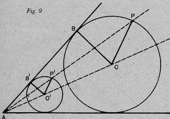
*Solución:* 1) se traza la bisectriz del ángulo; 2) se traza cualquier circunferencia  $O'$  tangente a los lados del ángulo; 3) al unir A con P se determina  $P'$ ; 4) por P //  $\overline{P'O'}$  determina el centro O de la circunferencia pedida; 5) se dibuja  $\odot(O, \overline{OB})$ .
