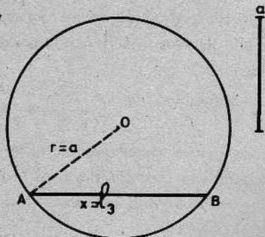
2ª construcción:  $x =$  altura de un  $\Delta$  equilátero de lado  $= 2a$  (Fig. 18).
