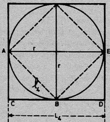
**Construcción:** Se trazan dos diámetros  $\perp$  y las tangentes en sus extremos. Resulta  $CD = L_4$  (Fig. 4).
