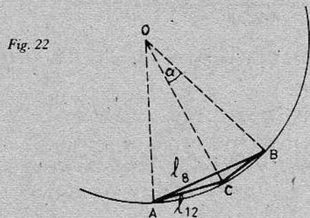
Si  $\overline{AB} = l_8$ , el  $\angle AOB = \frac{360}{8} = 45^\circ$  y si
