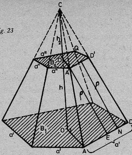
Se obtiene  $h_2 = \frac{h\sqrt{B_2}(\sqrt{B_1} + \sqrt{B_2})}{B_1 - B_2}$ , se reemplaza este valor en a):
