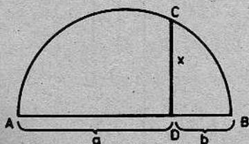
$1^o$  Construcción: basada en el  $2^o$  Teorema de Euclides se reduce a construir un  $\Delta$  rectángulo del cual se conocen las 2 proyecciones de los catetos en la hipotenusa; la altura es la  $\frac{1}{2}$  proporción geométrica.
