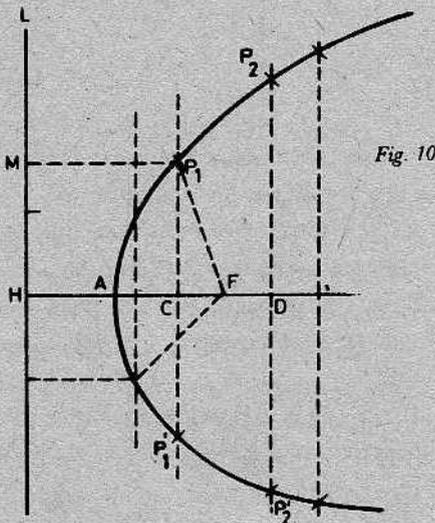
2) Por un punto  $C$  cualquiera del eje de simetría se traza una paralela a la directriz que se corta desde  $F$  con  $\odot (F, \overline{HC})$  determina  $P_1$  y  $P_1'$ .
